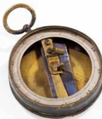
Obr. 3.6.08: Kapesní aneroid (NTM, inv. č. 3009; foto NTM, Sláma 2020)
