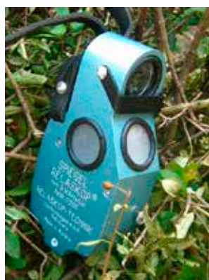
Obr. 3.3.22: Zrcadlový relaskop a pohled do jeho zorného pole (převzato z < https://en.wikipedia.org/wiki/Relascope >)
