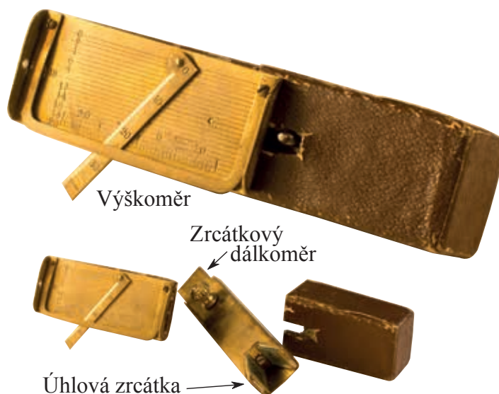
Obr. 3.3.16: Dendrometr DZK (NTM, inv. č. 2991; Leischner, foto Kotál 2019)
