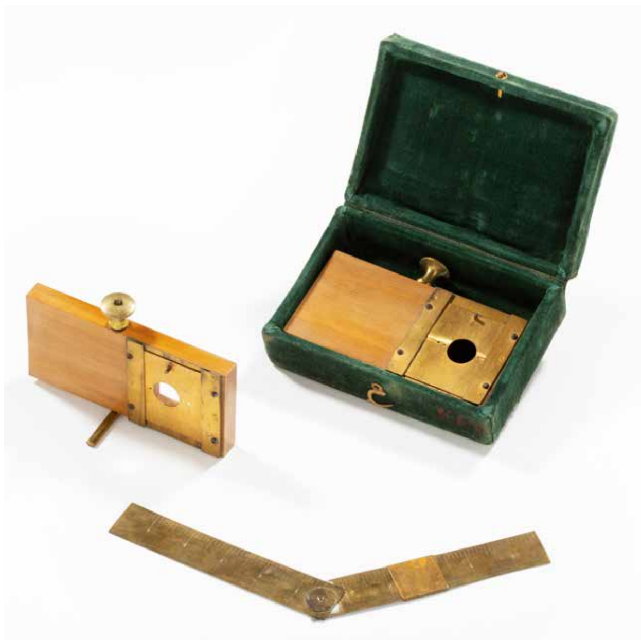
Obr. 3.1.24: Fotografie údajného heliotropu (NTM, inv. č. 3007; foto NTM, Sláma 2020)
