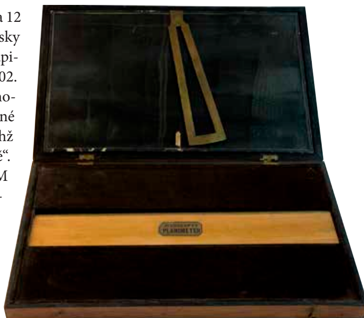
Obr. 3.1.02: Gangloffův planimetr z roku 1856 (NZM Ohrada, inv. č. 60730; foto Kotál 2019)
