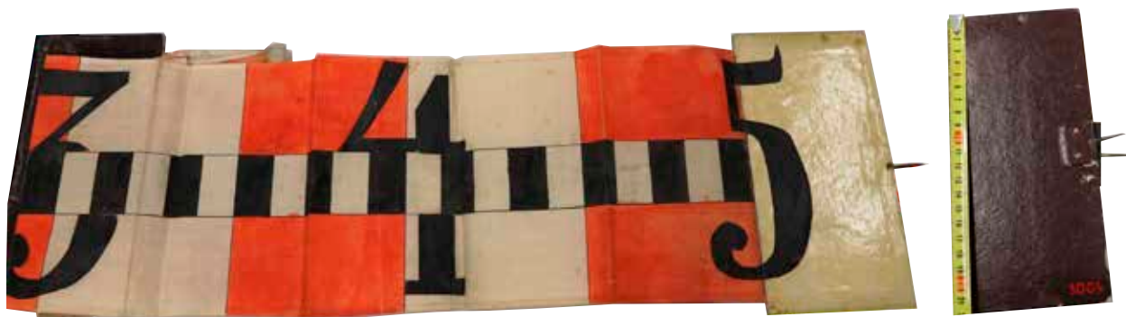
Obr. 3.3.06: Distanční pásmo (NTM, inv. č. 3004; foto Kotál 2019)
