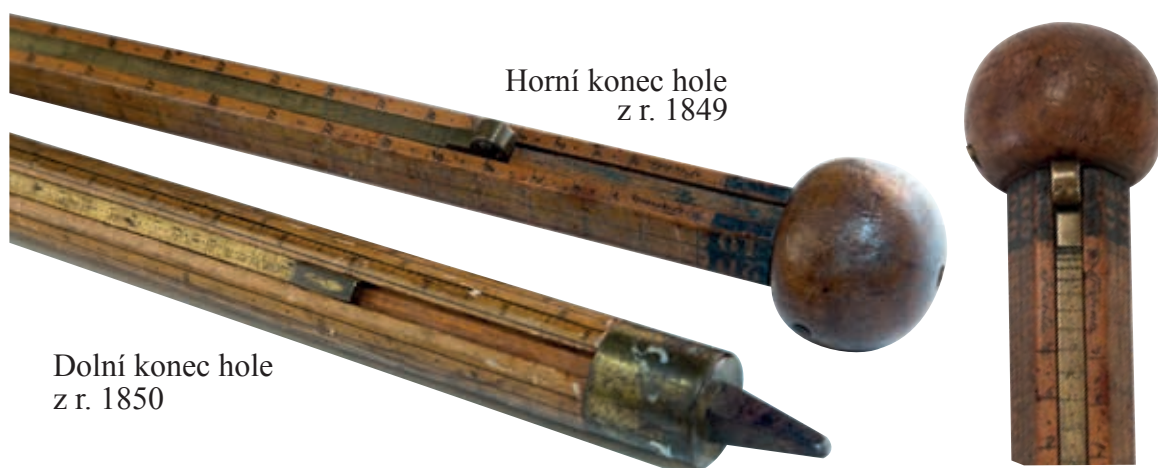
Obr. 3.2.09: Kubírovací hole (NTM, inv. č. 2992 a NZM Ohrada, inv. č. 44017; Leischner, foto Kotál 2019)
