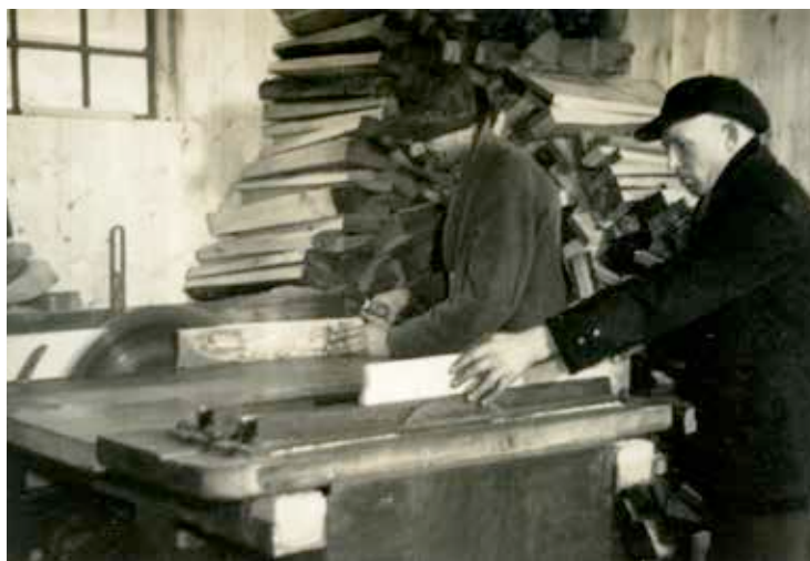
Obr. 3.4.10: Obsluha šindelky na Kozákové pile v Rožmitále (archiv PM)
