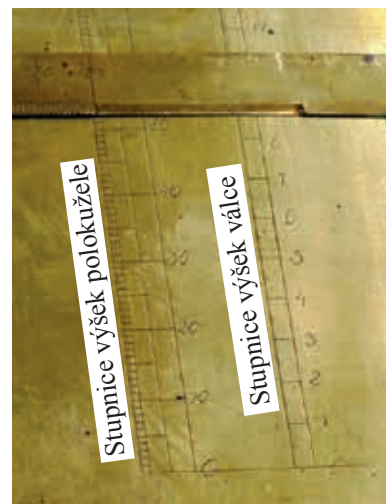
Obr. 3.2.22: Detail stupnic (NTM, inv. č. 2994; Leischner, foto Kotál 2019)
